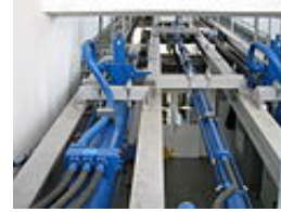
Hydraulikzylinder zur Seilspannung
